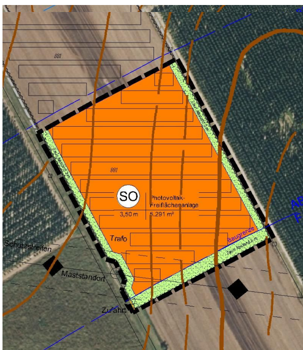
Bebauungsplan für die Erweiterung des Anlagenteils auf der Flurnummer 881 in der Gemarkung Appersdorf der geplanten Photovoltaik-Freiflächenanlage Elsendorf - Erweiterung
